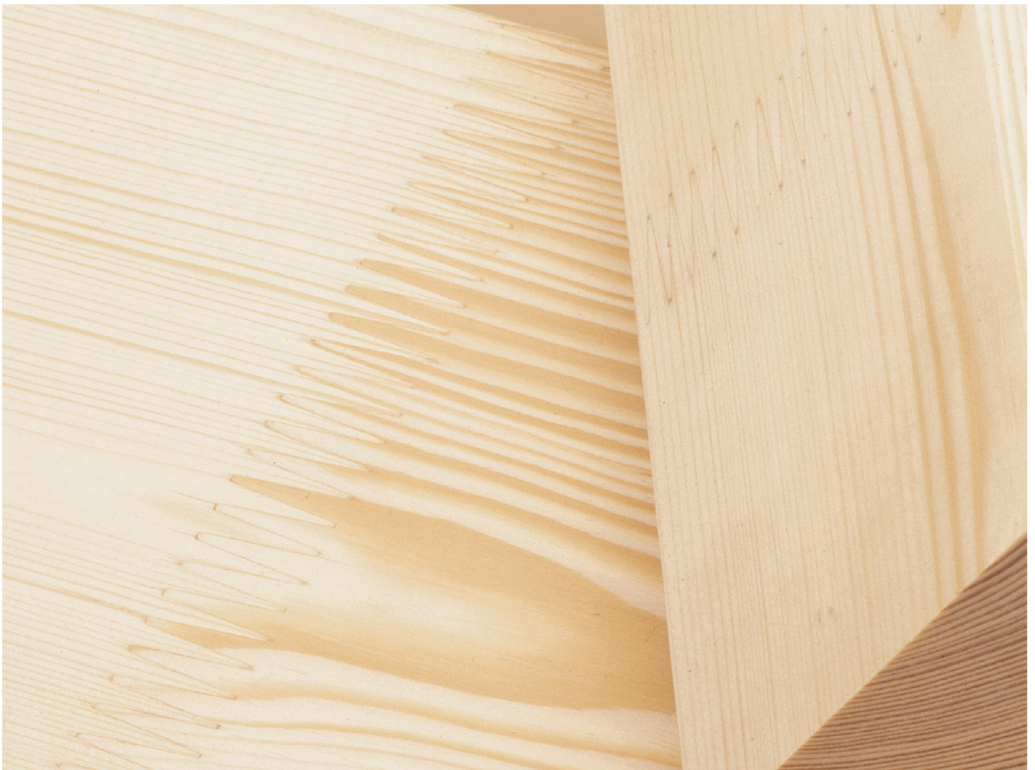
11 | La colle des entures de l'aboutage est à peine visible du fait de sa couleur claire.
